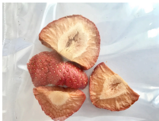
Joonis 23 UV-barjäärita pakendis külmkuivatatud materjali värvuse kadumine
